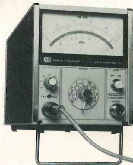
Il sensore del nuovo Sistema Hewlett-Packard di misura a microonde è probabilmente il più piccolo che abbiate mai visto. Comunque è certamente il più preciso: R.O.S., da 30 MHz a 12,4 GHz, inferiore a 1,2; fino a 18 GHz, inferiore a 1,3.
