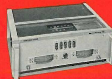
Fig. 10 - Ponte universale per misure di resistenza
