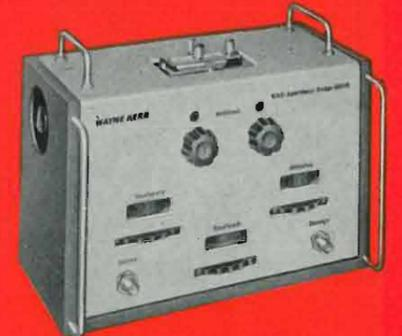
Fig. 8 - Ponte per misure d'ammiettanza VHF
