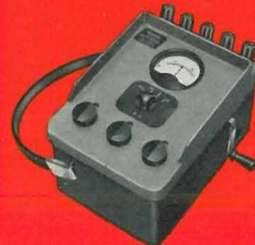
Fig. 9 - Misuratore di terre ad asseramento
