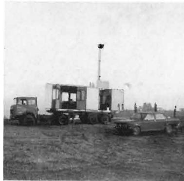
La copertina rappresenta il contenitore attrezzato da base mobile per il radiorilevamento delle prestazioni su strada di una autovettura. Tale base mobile comprende un sistema interferometrico per la misura della velocità del veicolo ed un sistema numerico di trasmissione dati. Nella stessa immagine è visibile il sistema automatico di sollevamento e puntamento dell'antenna con palo telescopico ed una vettura attrezzata per l'esecuzione delle misure (vedi articolo a pag. 118).
