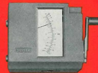
Fig. 7 - Misuratore di isolamento tascabile
